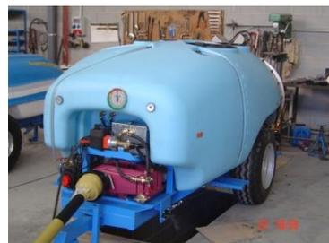
En la parte delantera del chasis va cogido al enganche que se acopla a la barra del hidráulico del tractor. También en la parte delantera del chasis, se encuentra el pie de descanso ref. 0010500, una rueda giratoria regulable, que sirve de apoyo a la máquina cuando esta no se encuentra enganchada al tractor. Asimismo en esa parte delantera van acoplados los catadióptricos reflectantes delanteros.
