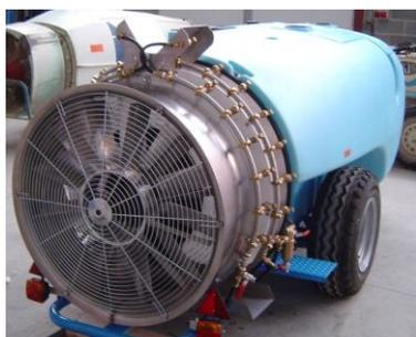
El ventilador se encuentra en el interior de la carcasa del cabezal y encerrado totalmente en ella. El acceso a este ventilador está totalmente bloqueado por las rejillas que lleva tanto en la parte delantera como posterior y que están fabricadas de acuerdo a la Normativa UNE-EN ISO 13857.
